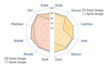
Effet épilame initial bon. Bonne résistance aux lavages. Ces épilames sont plus sensibles à la propreté de la pièce que l'épilame 8980-8982.
