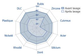
Effet épilame initial bon. Résistance aux lavages correcte. Cet épilame est peu sensible à la propreté de la pièce.
